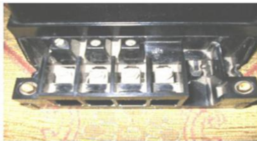
Gambar 3.11. Terminal Arus dan Tegangan
